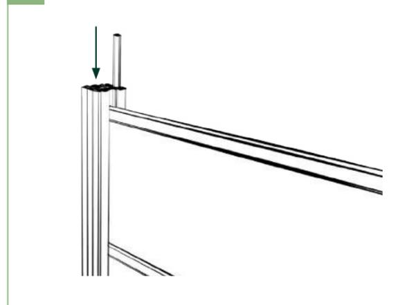
8 | Die Pfostenabdeckleisten von oben in die Pfostennut einschieben und mit der Unterkante des Pfostens bündig abschließen.
