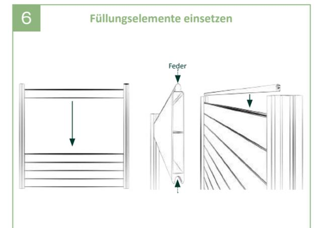
6 | Die Füllungselemente nacheinander von oben einschieben, dabei die Feder der Füllungselemente nach oben ausrichten. Mit dem Abschlussprofil abschließen.
