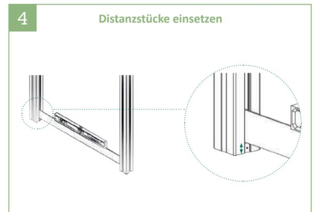
4 | Zuerst auf einer Seite das Distanzstück befestigen. Das Distanzstück der zweiten Seite mit Hilfe eines Füllungs-elementes und einer Wasserwaage ausrichten und befestigen.
