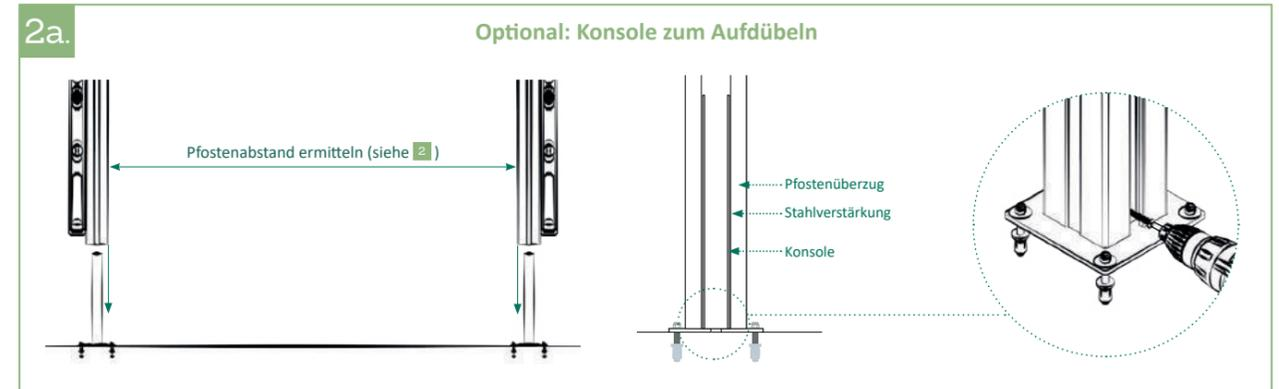
2a | Ausrichtung der Konsolen bei aufgesteckten Pfosten, danach aufdübeln. Der Pfostenüberzug und die Stahlverstärkung schließen nach dem Aufsetzen des Pfostens bündig ab.\*
