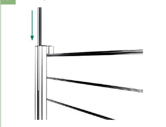
7 | Die Pfostenabdeckleisten von oben in die Pfostennut einschieben und mit der Unterkante des Pfostens bündig abschließen.
