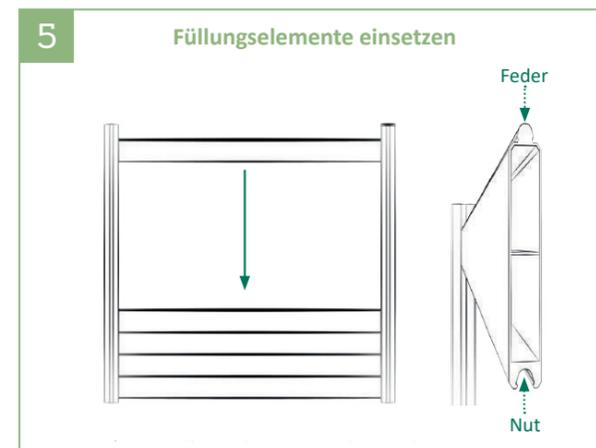
5 | Die Füllungs-elemente nacheinander von oben einschieben, dabei die Feder der Füllungs-elemente nach oben ausrichten.
